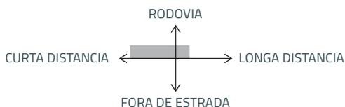
O Bridgestone R163S é um pneu radial sem câmara desenvolvido para uso em eixos direcionais, livres e de tração moderada de caminhões e ônibus, em perímetro urbano pavimentado.
